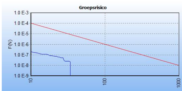
Figuur 7 FN-curve van gastransportleiding W-533-12 in de huidige situatie. De ligging van deze leiding is hiernaast in het groen weergegeven op een topografische kaart.
