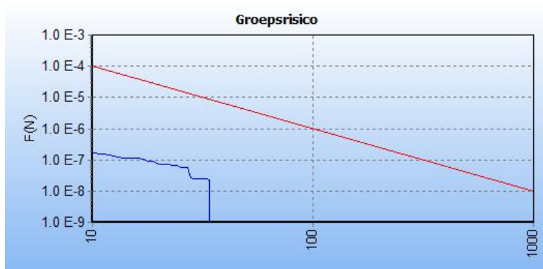
Figuur 9 FN-curve van gastransportleiding W-533-12, toekomstige situatie. De ligging van deze leiding is hiernaast in het groen weergegeven op een topografische kaart.
