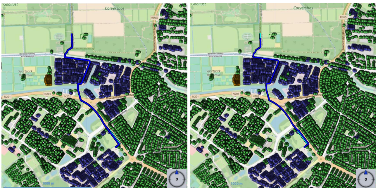
Figuur 2 Ligging van gastransportleiding W-533-12. De ligging van de leiding in de huidige situatie is in de linker afbeelding weergegeven in het donkerblauw, en de leiding na de verlegging is in de rechter afbeelding in het donkerblauw weergegeven.
